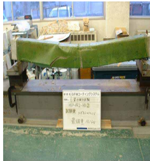
含浸接着工法による補強方法
