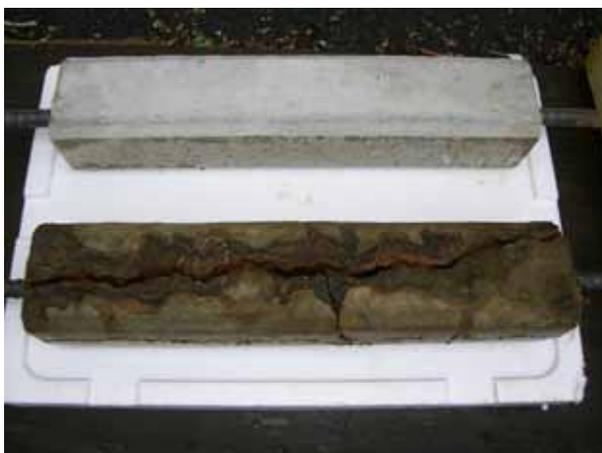
写真14 腐食試験（シート無し）
