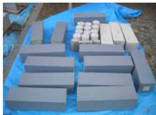
図4 モルタル・無筋コンクリートの曲げ試験
