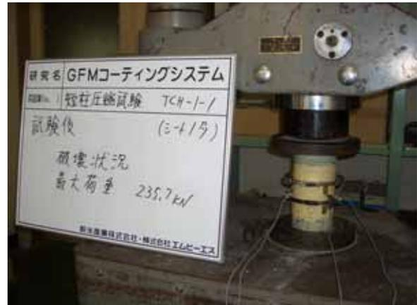
写真11 圧縮試験状況(部分コーティング)
