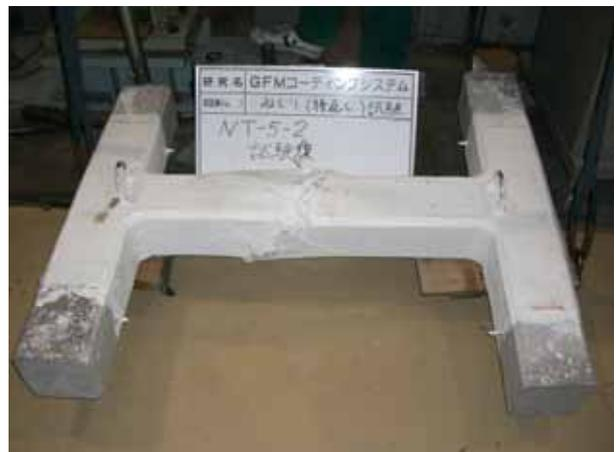
写真13 ねじり試験(性能レベル5)
