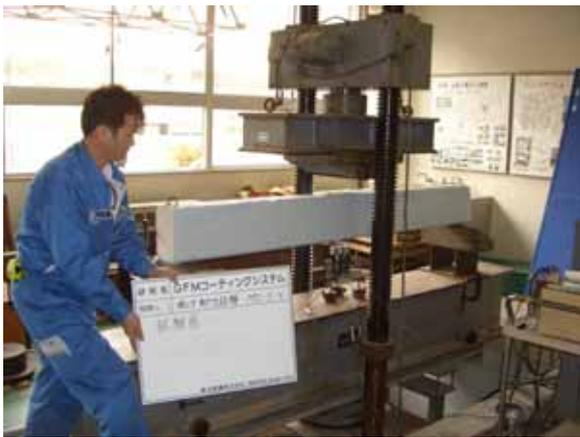
写真6 曲げ試験前
