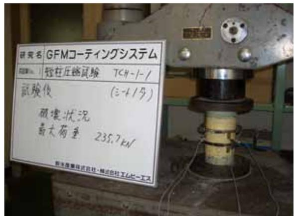
写真 1 3 圧縮試験状況 (部分コーティング)
