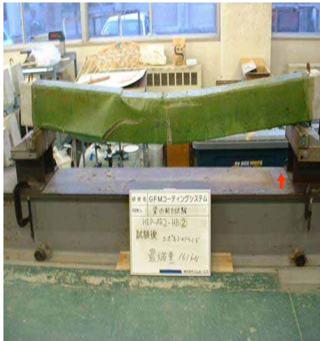
アラミド繊維シートによる 既存コンクリート構造物の補強方法
